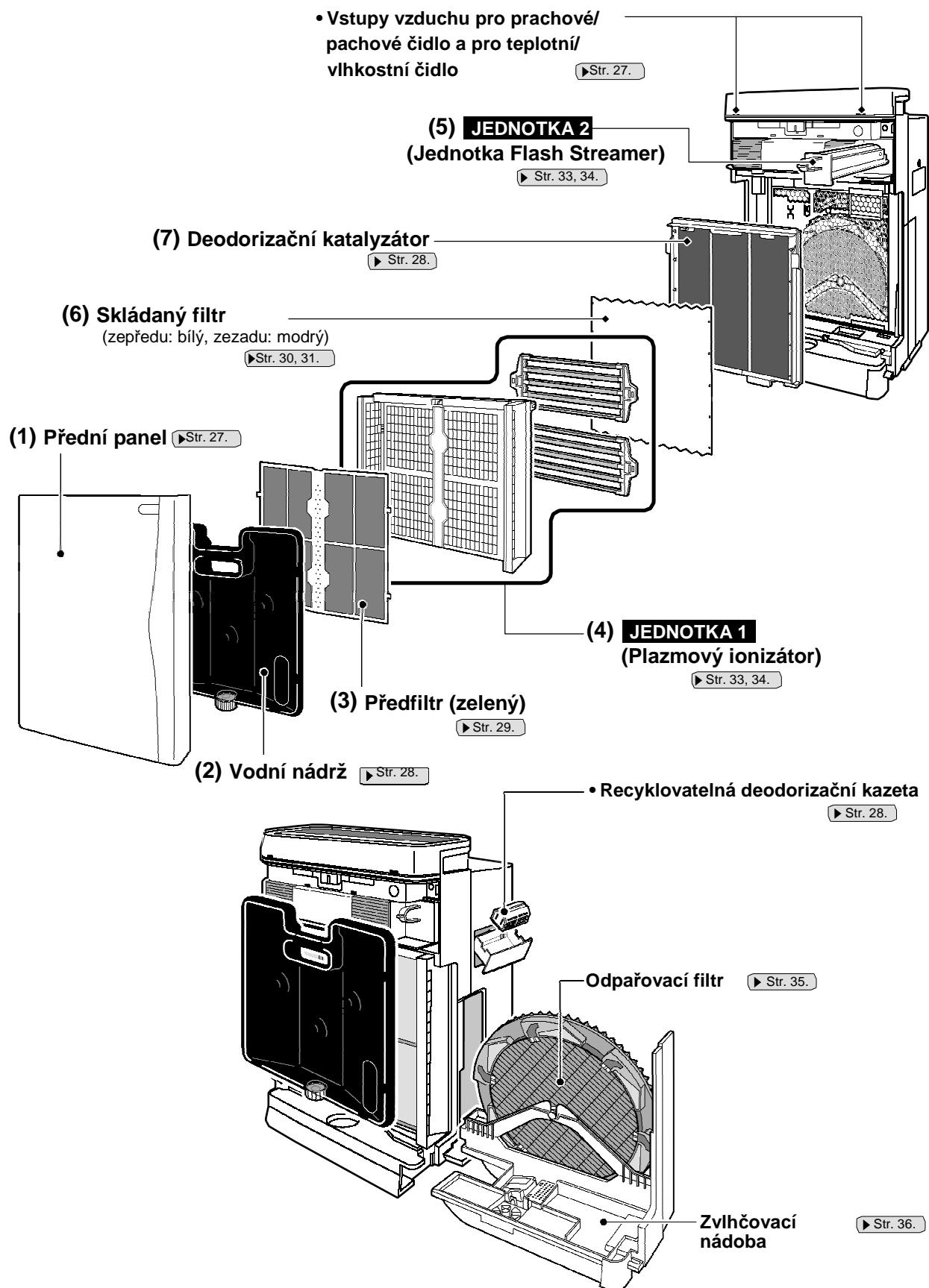
Chcete-li vyčistit zvlhčovací nádobu nebo odpařovací filtr, nejdříve sejměte (1) přední panel a vyjměte (2) vodní nádrž.
