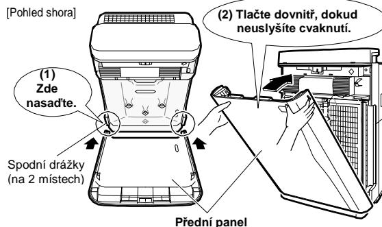
**Přední panel správně nasadíte tak, že na něj budete tlačit, dokud neuslyšíte cvaknutí zleva i zprava. Není-li správně nainstalovaný, bezpečnostní spínač může vypnout a zabránit spuštění jednotky.** ▶ Page 27.
