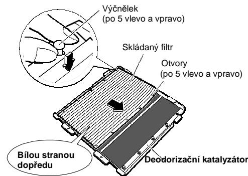
(3) Zasuňte skládaný filtr pod příchytky (4) na horní a dolní straně deodorizačního katalyzátoru.
