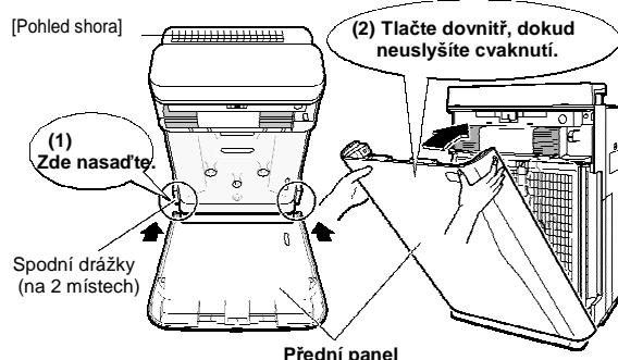
Přední panel správně nasadíte tak, že na něj budete tlačit, dokud neuslyšíte cvaknutí zleva i zprava. Není-li správně nainstalován, bezpečnostní spínač může vypnout a zabránit spuštění jednotky.
